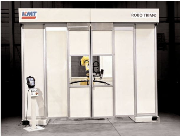
El encerramiento de acero del RT-500 con puertas manuales al frente protege al operador mientras el robot esta trabajando.
